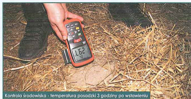
Kontrola środowiska - temperatura posadzki 3 godziny po wstawieniu
